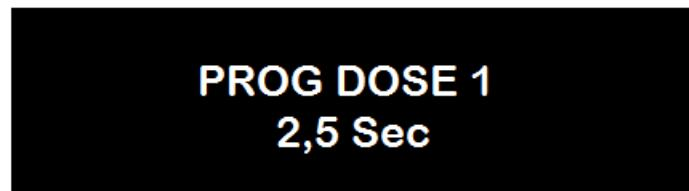
Taste **PROG** drücken um die Zeit-Einstellung der Menge 1 ändern zu können. Die zweite Zeile fängt an zu blinken. Taste **1(-)** betätigen um den Wert zu senken oder Taste **2(+)** um den Wert zu steigern. Die Tasten **1(-)** oder **2(+)** gedrückt halten um die Werte viel schneller ändern zu können.
